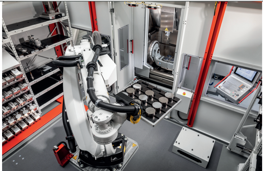
Variable Speicheroptionen: Das Robotersystem RS2 kann je nach Anwendungsfall mit unterschiedlichen Speichermodulen ausgestattet werden. © Hermle
